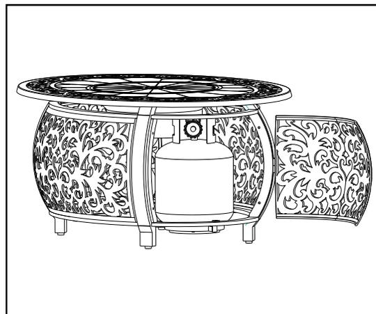
Ne rangez pas une bouteille de GPL de rechange sous l'appareil ou à proximité de celui-ci.
